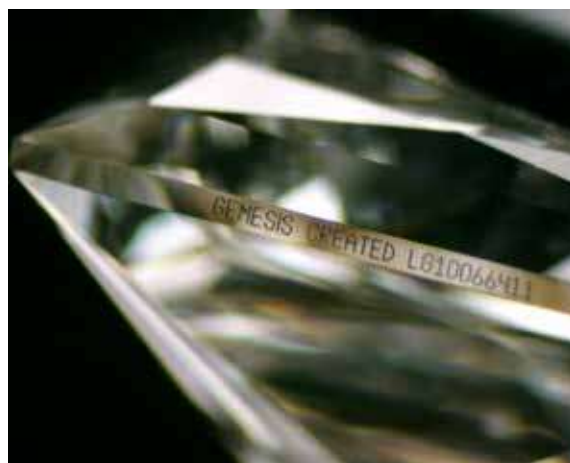
Figuur 2. Inscriptie op de rondist van een lab-grown diamant, met de naam van de producent (in dit geval Gemesis) en een nummer met de afkorting LG, dat laboratory-grown aangeeft.
