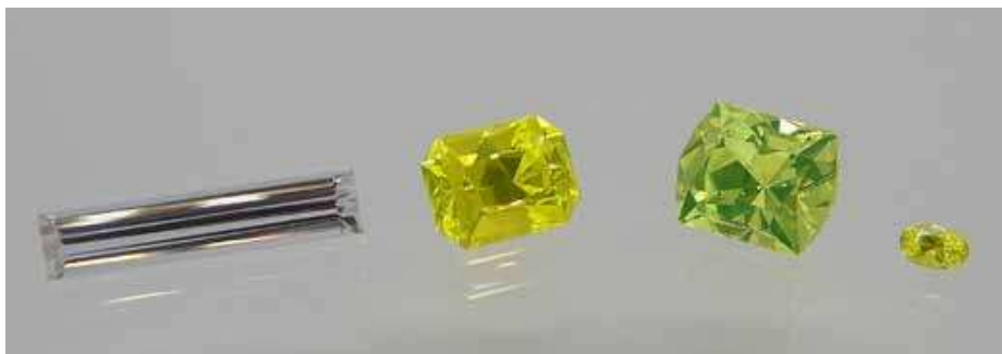
Figuur 2. Synthetische lumogranaten, van links naar rechts LYSO (6,11 ct), YAG(Ce) (4,04 ct), LuAG (8,25 ct), GAGG (0,33 ct)
