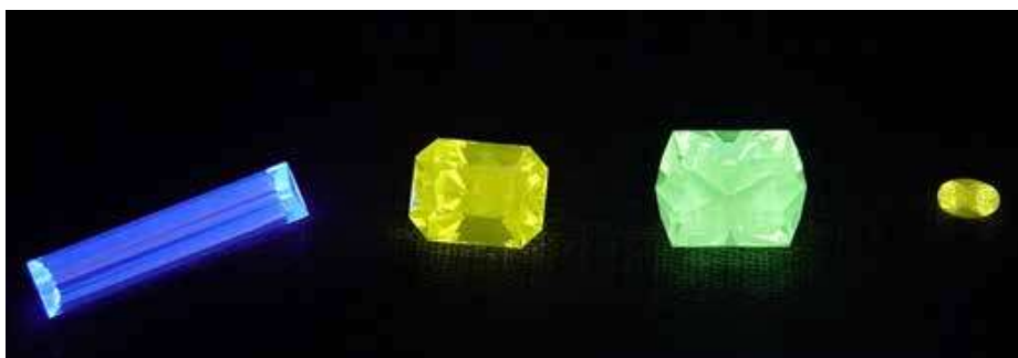
Figuur 3. Synthetische lumogranaten in dezelfde volgorde vertonen zeer sterke fluorescentie, goed waarneembaar in het donker onder een UV lamp of blacklight, maar ook zeer opvallend buiten in het zonlicht.
