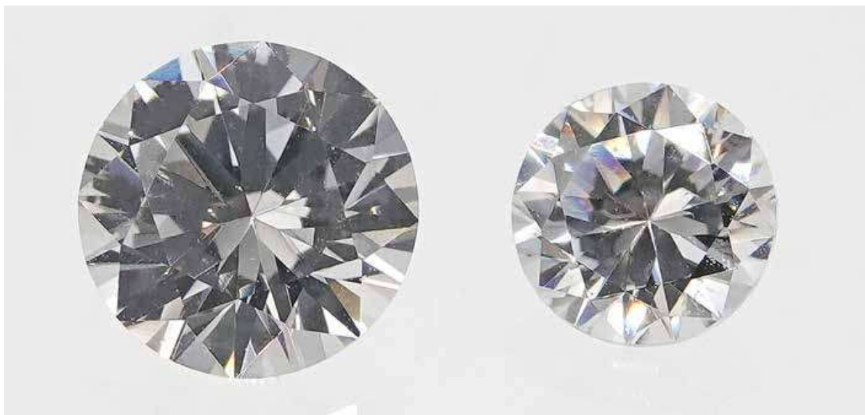
Figuur 1. YAG en GGG waren in de zeventiger jaren maar een paar jaar populair als imitatie van diamant, vlak voor de komst van Cubic Zirconia. De YAG links weegt 2,24 ct, de GGG rechts weegt 1,90 ct.
